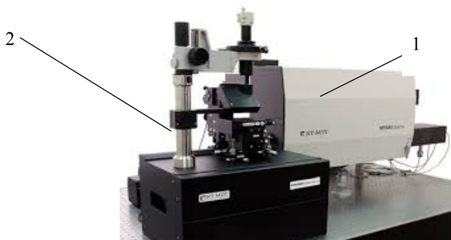
Рис. 1. Зондовая нанолaborатория ИНТЕГРА: 1 – спектральный блок; 2 – аналитический блок
